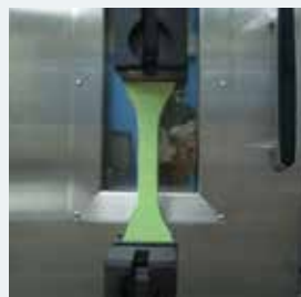
JIS A 6021引張性能試験の例
